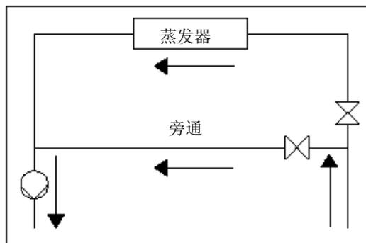
只有在使用流量比规定流量大许多的情况下才考虑使用。因为使用旁通回路将使蒸发器冷水出口的温度比使用的冷水温度低，而蒸发器冷水出口温度过低既不经济又不安全。
